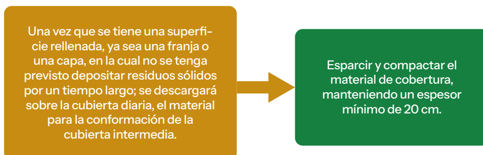
Figura 51. Cobertura intermedia para el cubrimiento de la celda.
